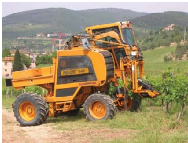
(F) - L'utilizzo del GPS può permettere di dividere il vendemmiato in funzione di parametri qualitativi, nei due cassoni che vengono scaricati separatamente ( Alma - Olmi )
