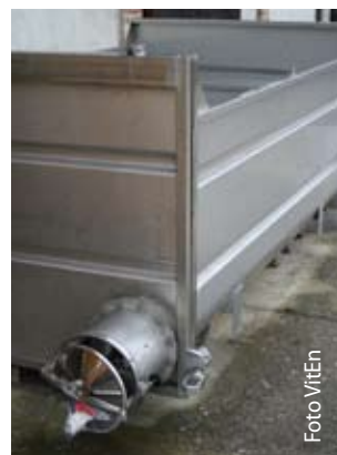
(D) - Carro con coclea laterale in grado di diventare autoscaricante con il ribaltamento parziale da un lato (UT2)
