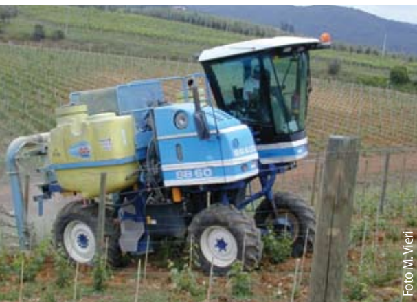
(A) - Trattamenti eseguiti con vendemmiatrice semovente attrezzata per la multifunzione (New Holland - Braud)
