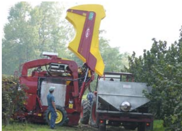
(F) - L'utilizzo del GPS può permettere di dividere il vendemmiato in funzione di parametri qualitativi, nei due cassoni che vengono scaricati separatamente ( Alma - Olmi )
