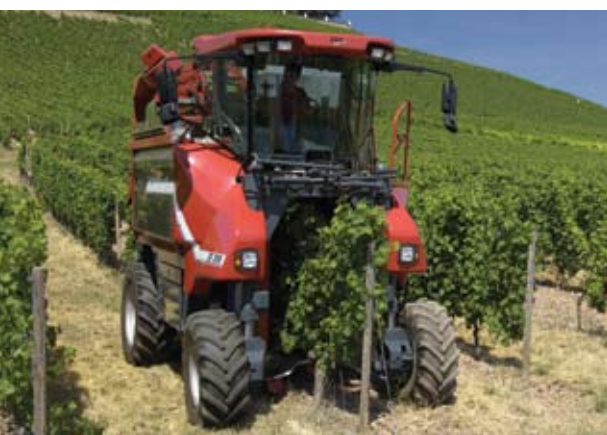
(B) - Semovente a scuotimento orizzontale (ponte basso e cabina centrale) al lavoro in un vigneto disposto a rittochino (Ero)
