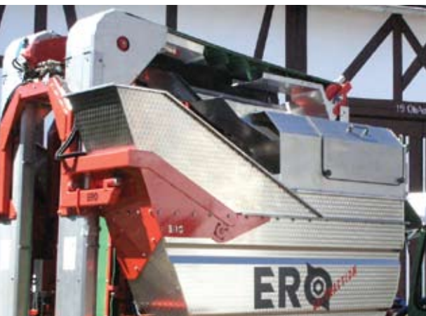
(A) - Dispositivi per la pulizia dell'uva in una macchina trainata (Ero)
