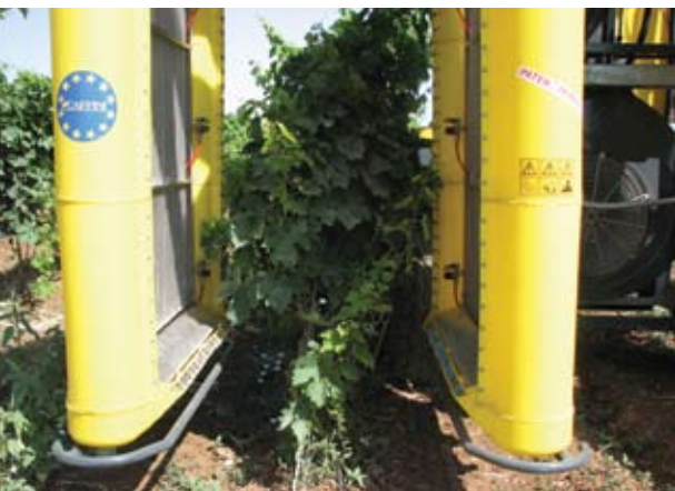
(C) - Particolare del sistema di polverizzazione e trasporto del prodotto, a mezzo dell'aria che fuoriesce con la miscela fitosanitaria dagli ugelli per garantire una penetrazione ottimale all'interno della vegetazione. Un innovativo sistema a lame, impedisce la fuoriuscita del prodotto chimico dai pannelli, sia nel senso verticale che orizzontale (Caffini)
