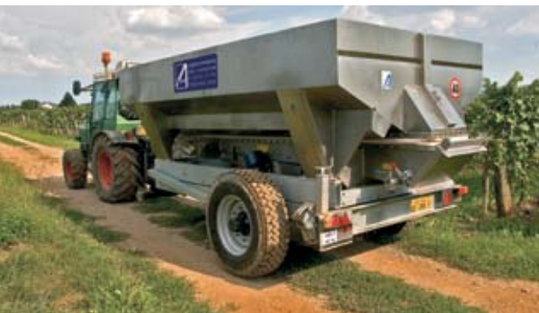
(B) - Rimorchio elevatore, autoscaricante tramite rotovibrazione (Defranceschi Amos)
