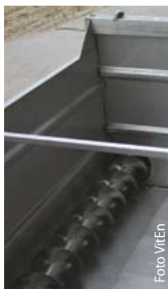
(D) - Carro con coclea laterale in grado di diventare autoscaricante con il ribaltamento parziale da un lato (UT2)
