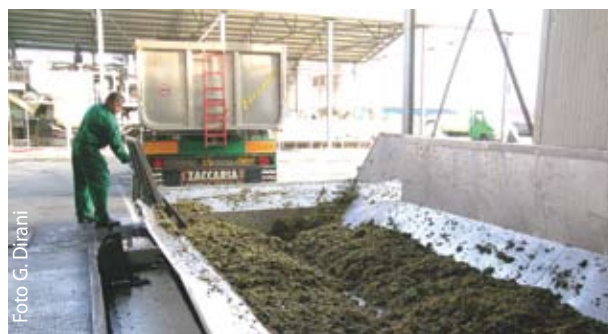
(F) - Lo scarico, specie per grandi capacità, è bene sia fatto nel lato corto del convogliatore, per evitare trasbordi ( Zaccaria )
