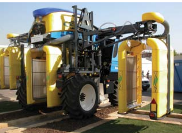
(B) - Macchina scavallante predisposta per i trattamenti antiparassitari, munita di recupero del prodotto, che viene filtrato e riutilizzato. Ciò consente di diminuire le perdite per deriva e mancato bersaglio (Caffini)
