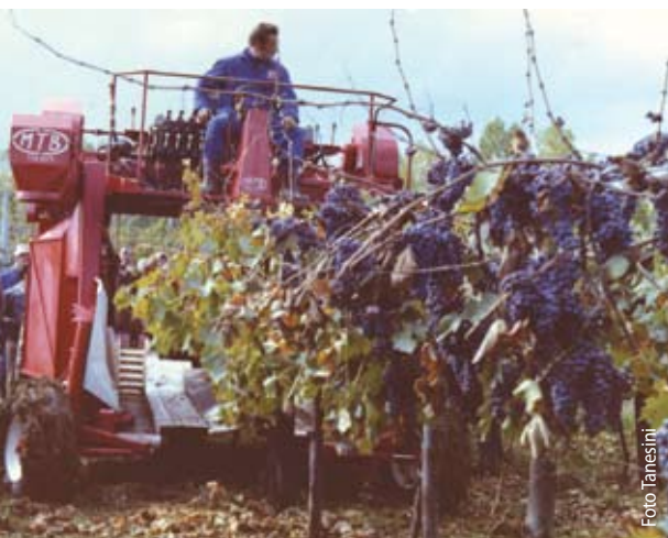
(B) - Uno dei primi modelli di vendemmiatrice a scuotimento verticale scavallatrice realizzata in Italia dalla MTB ad iniziare dal 1971
