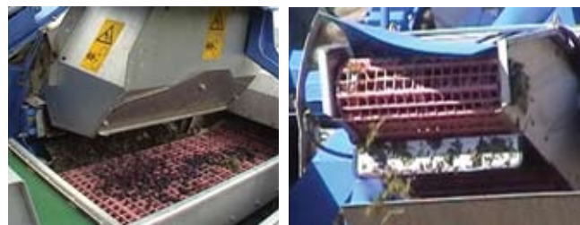
(E) - Uva perfettamente pulita in fase di scarico nelle tramogge laterali, grazie all'aspirazione effettuata sia nella parte bassa che in alto (Alma - Olmi)
