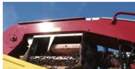
(E) - Uva perfettamente pulita in fase di scarico nelle tramogge laterali, grazie all'aspirazione effettuata sia nella parte bassa che in alto (Alma - Olmi)
