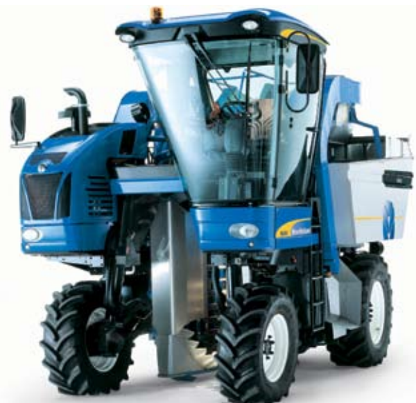
(A) - Vendemmiatrice semovente di ultima generazione con ponte alto, quindi obbligatoriamente con la cabina laterale (New Holland - Braud)
