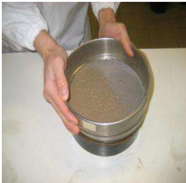
Setacciatura del campione a 0,5 mm
