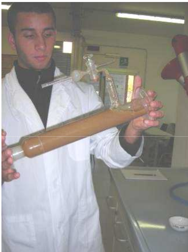
Agitazione del levigatore
