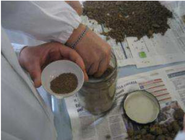
Prelievo del campione di terra fine
