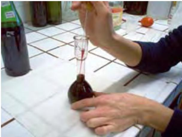
3) Quando il campione è a 20°C esatti, lo si porta a volume con una pipetta pasteur
