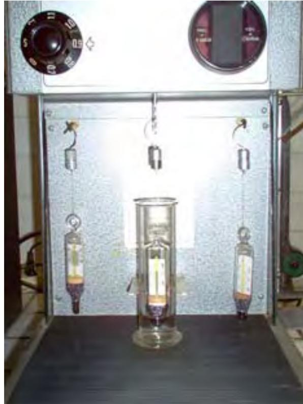
**Si legge la densità del campione con la bilancia idrostatica e si consultano le tabelle per ottenere il grado alcolico del campione in esame**
