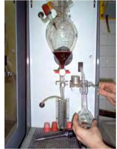
**Si pone il matraccio sotto al tubo di uscita del distillato**
