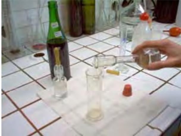
**1) Si versano alcuni ml di distillato nel cilindro da 100ml per la bilancia idrostatica**
