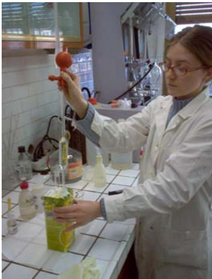
**Si prelevano 50ml esatti di vino con una pipetta a bolla a doppia tacca**
